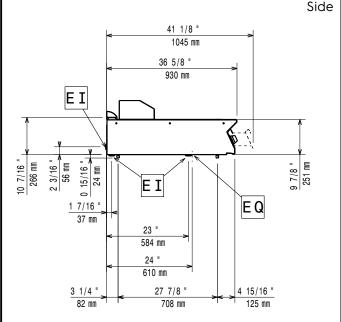
Electrical inlet (power) EQ **Equipotential screw**
